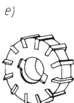
Rys. 27-3. Rodzaje frezów: a) pojedynczy walcowy, b) zespołowy walcowy, c) walco-wo-czołowy, d) głowica trzpieniowa, e) głowica nasadzana, f) frez tarczowy trzystronny, g) piłkowy, h) tarczowy trzystronny o wstawianych ostrzach, i) kątowy, j) palcowy, k) trzpieniowy, l, m) kształtowe, n) zespołowy do rozwiertaków, o) do gwintowników, p) do frezów, r) do kół zębatach, s) do ślimacznic
